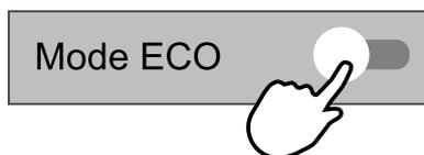
Mode ECO est une fonction d'économie d'énergie qui limite partiellement le fonctionnement du chauffage. Elle ne peut être activée que si une batterie chaude est installée.
