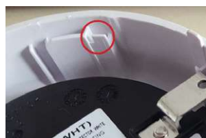
Ergot en plastique dans le fond du détecteur
