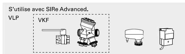
VLP, système de vannes modulable et indépendant de la pression
